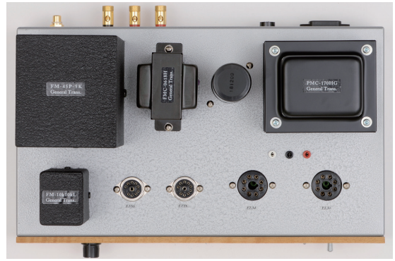
[写真2] シャシー天板上のトランス類、チョークコイル、真空管ソケットの配置。電源トランスの下はテスト端子
