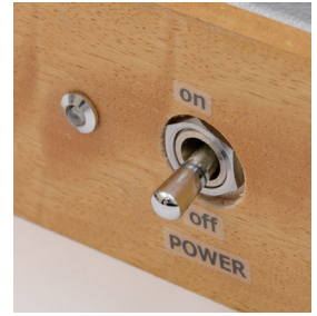
[写真7] ウッドパネルのポリウム、電源スイッチとLED部は丸孔を削り、ナットを沈めている
