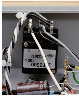
[写真6] 初段は対称型の増幅回路なので2連VRを使用
