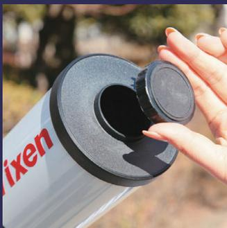
太陽像が明るすぎるときや熱による危険が心配なときは、口径を絞りましょう。写真は対物レンズのキャップの中心についている小さなキャップを外すと口径が絞れるタイプの望遠鏡です。厚紙やダンボールなどを利用して自作しても代用できます。
