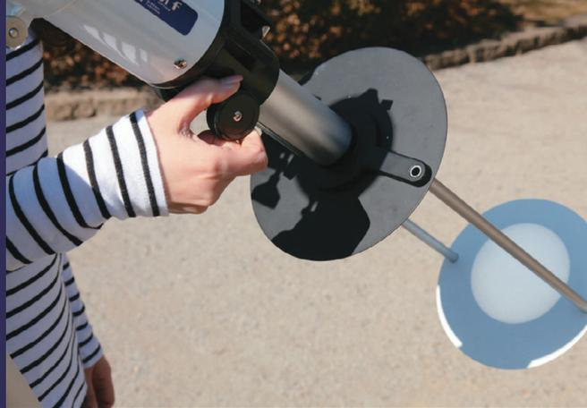
太陽投影板を使った観察は安全性が高く、多くの人が同時に観察する場合に適した方法です。接眼レンズを使って投影板に太陽像を投影します。太陽像を大きくしたいときは焦点距離が短いレンズ、小さくしたいときは焦点距離が長いレンズを使います。接眼レンズと投影板の間に頭を入れて、接眼レンズをのぞく人がいないように、常に気を配りましょう。
