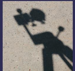
望遠鏡を太陽に向けるには、地面に映る鏡筒や投影板の影に注目。太陽の方向に向くと、鏡筒の影が断面図のように丸くなります。
