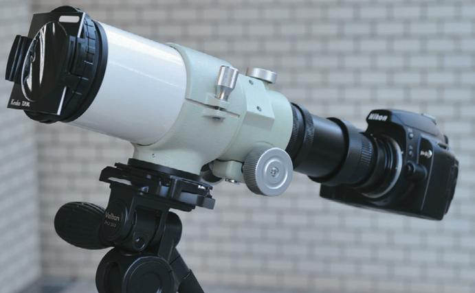
望遠鏡での撮影では、減光フィルターは必ず対物レンズの前につけます。写真の減光フィルターはフィルム状のフィルターをケンコーのペーパーマウントに取り付けたもの。鏡筒はタカハシFC-60CB。
