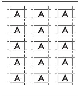
同じジョブを印刷用紙のサイズに繰り返し配置する面付け方法です。一度に大量の完成品を作ることができます。
