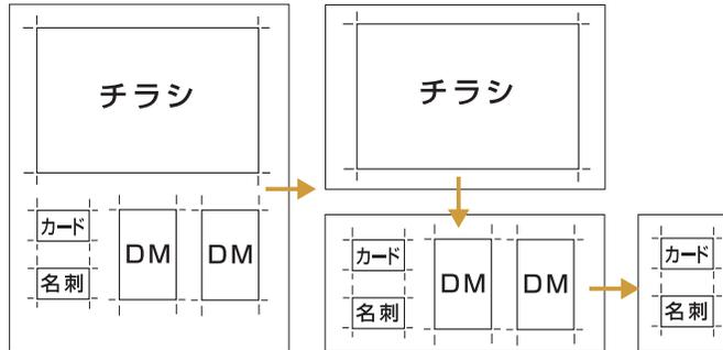
異なるジョブを1枚の用紙に配置します。配置のコツは、断裁が複雑にならないように、後工程も考えておくことです。上の例の場合、まず上下に分けて (大裁ち)、さらに下部分も細かい印刷物に切り分けます。
